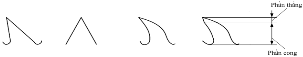
Hình 2.3: Các dạng răng của dao cắt
