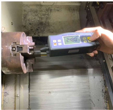
Hình 7 Khi v = 140 m/phút, s = 0,15 mm/vòng, t = 0,3 mm
