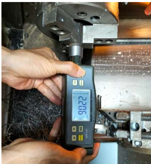
Hình 9 Khi v = 180 m/phút, s = 0,2 mm/vòng, t = 0,3 mm
