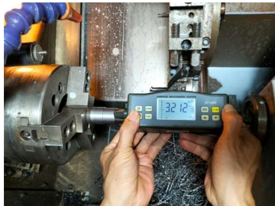
Hình 8 Khi v = 140 m/phút, s = 0,15 mm/vòng, t = 0,2 mm
