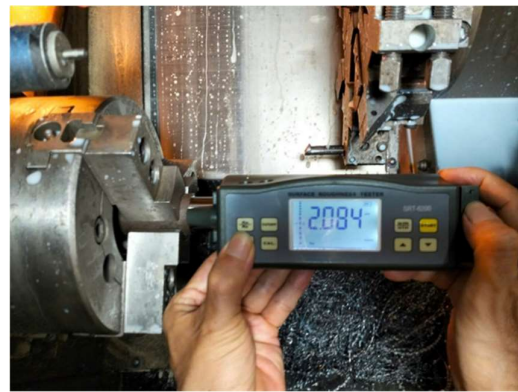
Hình 6 Khi v = 140 m/phút, s = 0,15 mm/vòng, t = 0,25 mm
