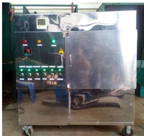
Hình 1 Máy sấy bơm nhiệt đã được chế tạo
