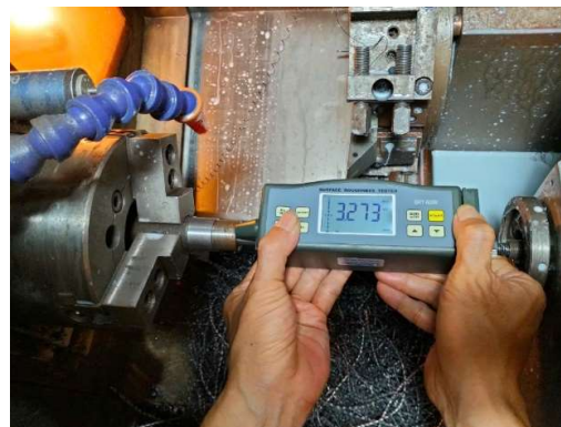
Hình 4 Khi v = 100 m/phút, s = 0,1 mm/vòng, t = 0,25 mm
