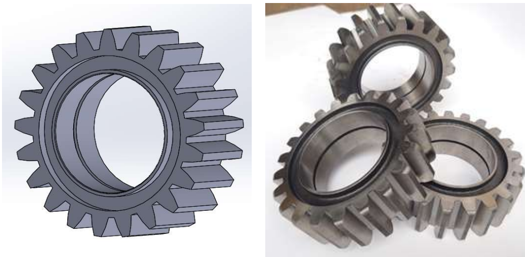
Hình 4 Các bánh răng hành tinh sau khi chế tạo
