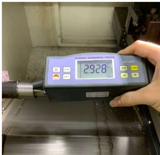
Hình 3 Khi v = 100 m/phút, s = 0,1 mm/vòng, t = 0,2 mm
