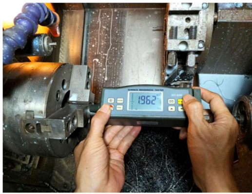
Hình 5 Khi v = 100 m/phút, s = 0,1 mm/vòng, t = 0,3 mm
