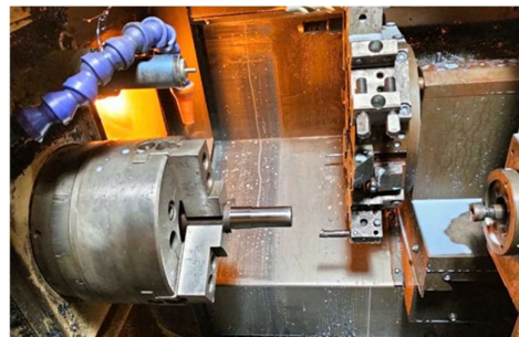
Hình 2 Gá phôi trên máy tiện CNC.
