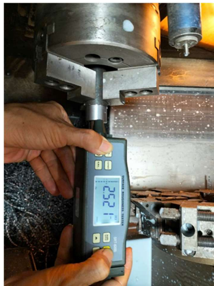
Hình 10 Khi v = 180 m/phút, s = 0,2 mm/vòng, t = 0,2 mm
