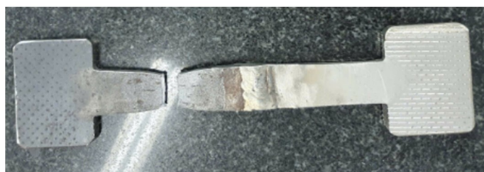
Hình 7 Mẫu sau khi xác định giới hạn bền kéo.
