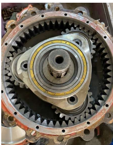
Hình 5 Bộ giảm tốc sau khi lắp ráp và trên xe bánh xích XCB.
