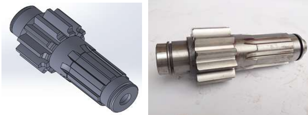
Hình 3 Trục và bánh răng trung tâm sau khi chế tạo
